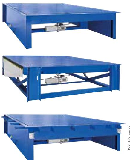
Le HTLV4, qui, par sa lèvre segmentée, offre la possibilité de charger ou de décharger aussi bien un camion qu'un véhicule utilitaire léger, assure une compensation de charge pour les véhicules légers. Ainsi par exemple, tout en préservant une pleine capacité de 60 KN pour les camions, lorsque le niveleur charge une fourgonnette, il se limite automatiquement à 20 KN afin de soulager les suspensions de ces véhicules plus légers.
